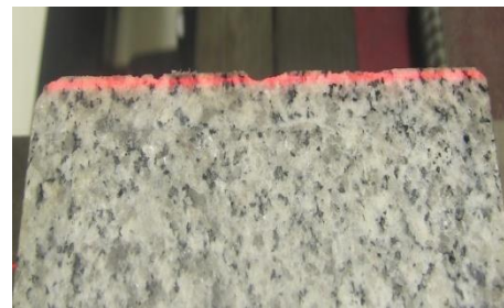
شکل (۱۳): مراحل اسکن سطح به‌وسیله لیزر
