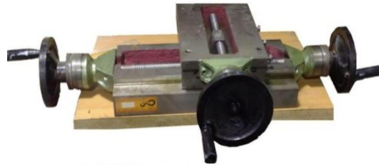
شکل (۷): میز صلیبی (X-Y)
