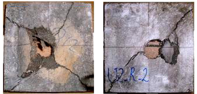
شکل ۱۰: الگوی گسیختگی نهایی U2 بر روی تکیه‌گاه گیردار بعد از ضربه نهم؛ (راست) وجه جلویی و (چپ) وجه پشتی Fig. 10. Final failure pattern of U2 on the rigid support after the ninth impact; (right) front face, (left) back face
