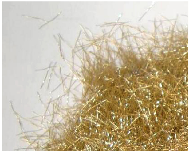
شکل ۱۶: ماکرو الیاف تولید شرکت صنایع مفتولی زنجان (بالا) و میکرو الیاف تولید شرکت STRATEC آلمان (پایین)
