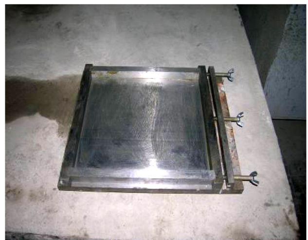
شکل ۳: قالب فولادی مورد استفاده برای ساخت پانل بتن الیافی
