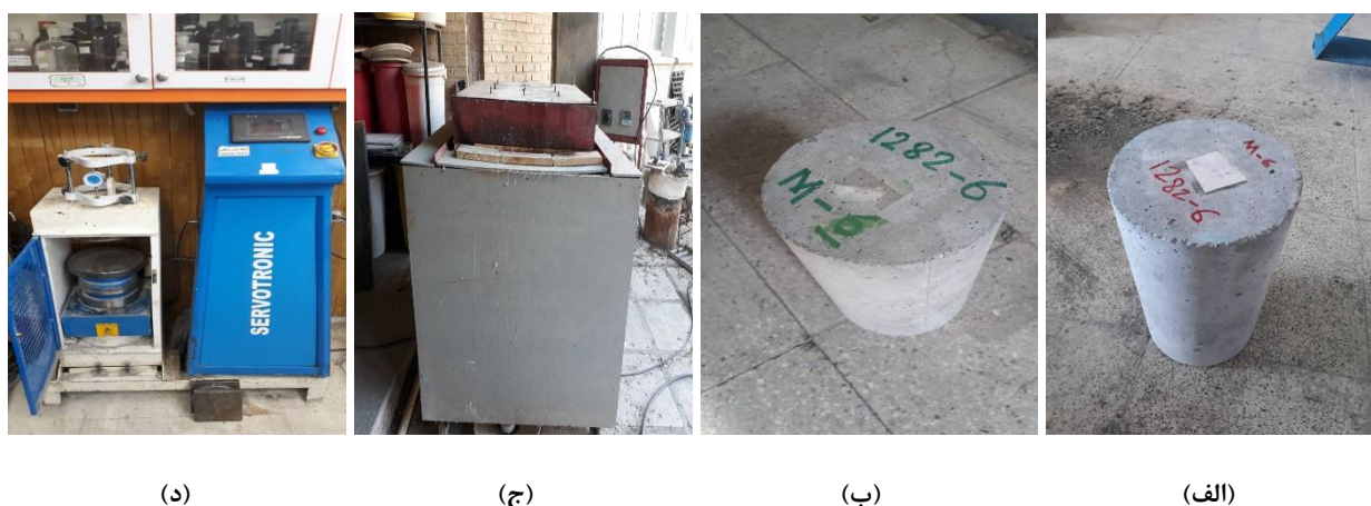
شکل ۳. تصویر (الف) نمونه‌ای در دمای محیط، (ب) نمونه‌ای پس از اعمال حرارت، (ج) کوره الکتریکی و (د) جک هیدرولیکی مورد استفاده
