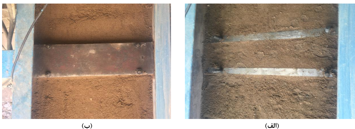
شکل ۳. نصب پی دامنه دار؛ الف) هم تراز شدن خاک با دامنه‌ها ب) بستن پی سطحی بر روی دامنه‌ها با چهار پیچ
