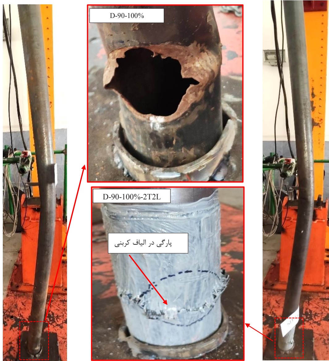
شکل ۱۸. حالت شکست ستون‌های انجام شده در آزمایشگاه و دارای آسیب در پایه
