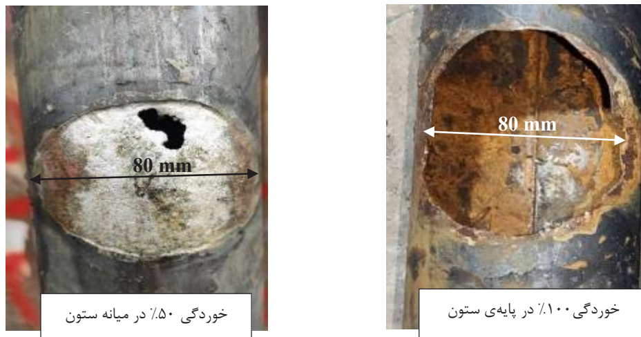
شکل ۵. نمونه‌ها بعد از اعمال خوردگی
