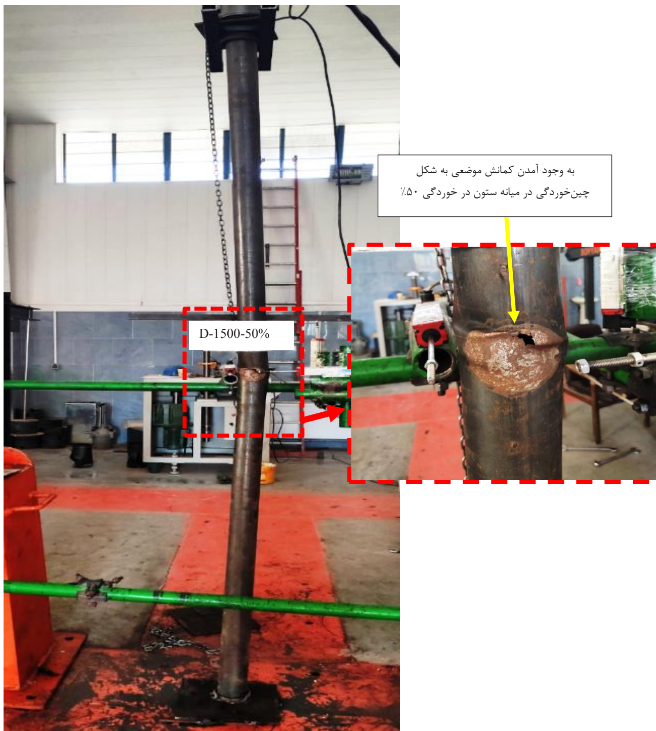
شکل ۱۶. حالت کماتش ستون با خوردگی ۵۰٪ در میانه انجام شده به صورت آزمایشگاهی
