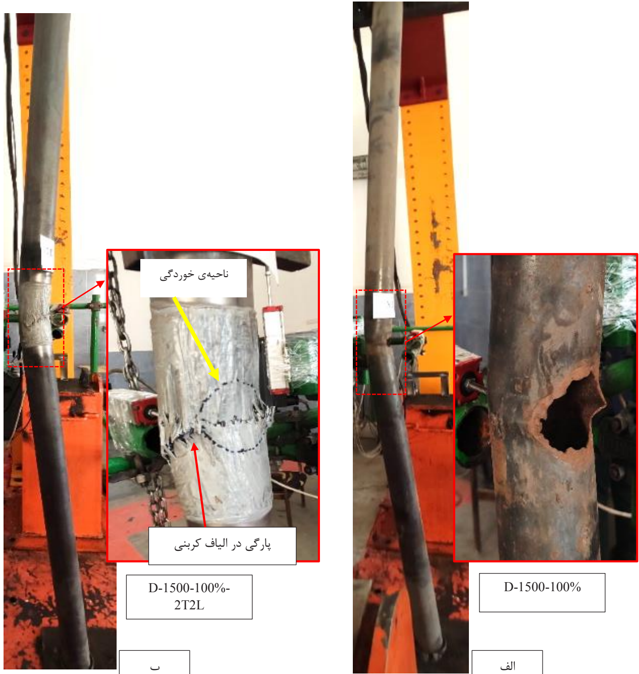
شکل ۱۷. حالت شکست ستون‌های انجام شده به صورت آزمایشگاهی و آسیب در میانه: الف) با آسیب ۱۰۰٪ و بدون مقاوم‌سازی، ب) با آسیب ۱۰۰٪ و مقاوم‌سازی شده با ۴ لایه الیاف کربنی
