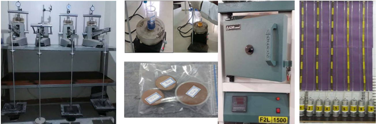
شکل ۳. تصویر برخی از دستگاه‌های استفاده شده و نحوه انجام آزمایش‌ها در این تحقیق (دستگاه نفوذپذیری، کوره الکتریکی، تیتراسیون خاک و دستگاه ادنومتر)
