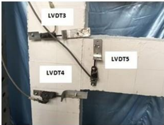
شکل ۱۱. جزئیات LVDT ها در گره اتصال Fig. 11. LVDTs in connection node Details of
