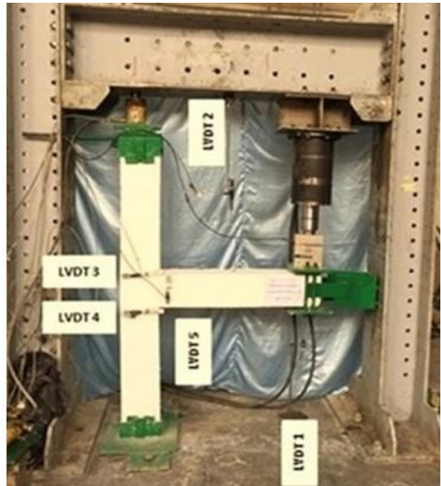
شکل ۱۰. دستگاه آزمایش به همراه تغییرمکان سنجها Fig. 10. Test setup and strain gauges
