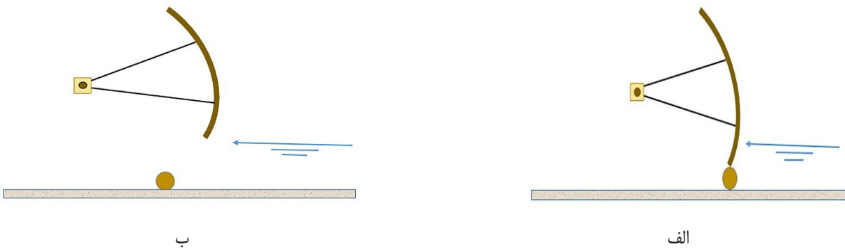
شکل ۴. نحوه قرار گرفتن آستانه دایره ای (حالت اول)، دریچه بسته (الف) و دریچه باز (ب)
